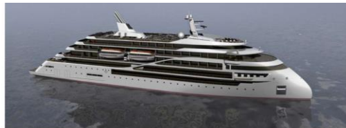
Skipstypen CX104 er 120 meter lang og blir utstyrt for polare strøk. Illustrasjon: Ulstein Group
